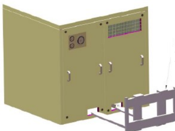
Рисунок 3 - Подъем агрегата со снятым корпусом
